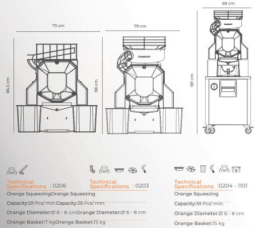
Motor:0,25 kwMotor:0,37 kw
